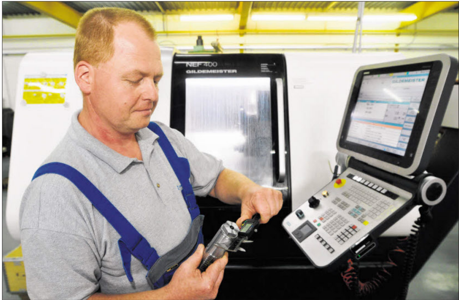
Präzises Fertigen ist bei der B&S Zerspantungstechnik wichtig. Hier prüft CNC-Dreher Jürgen Fickler eine Angussbuchse.
